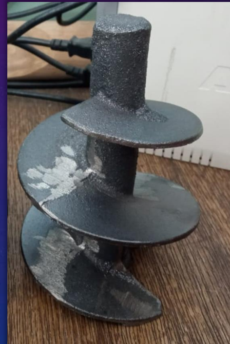
Деталь “Винт” до модернизации снятая с производства
