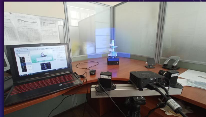
Сканирование детали – “Винт” термической печи отжига
