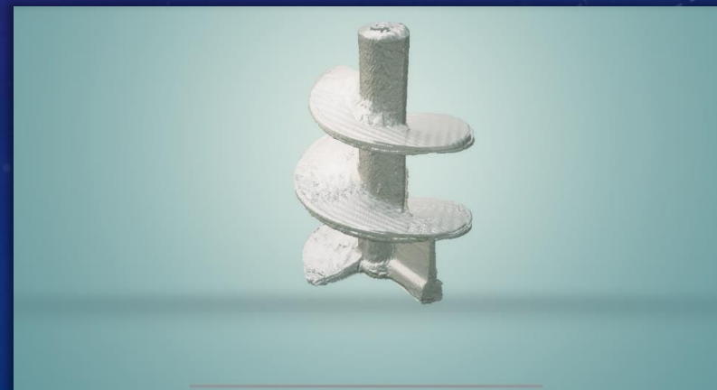
STL модель полученная путем отцифрования детали
