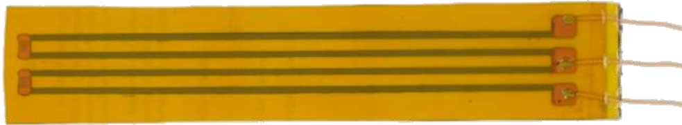
Примерный вид прототипа малогабаритного плоского нагревателя для терморегулирования
