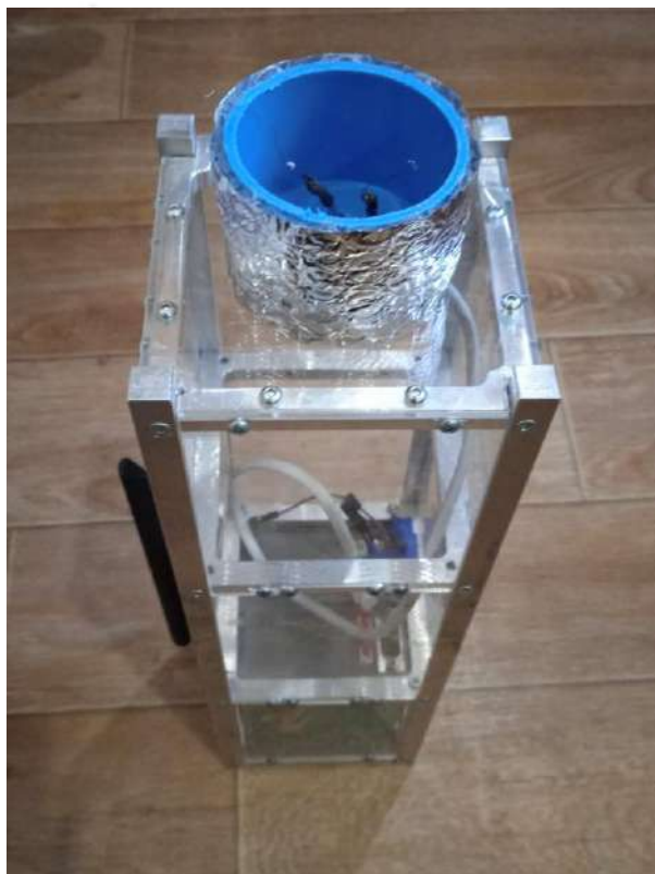
Макет двигателя «Импульс-У» на макете КА CubeSat 3U
