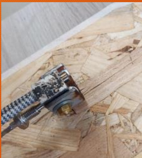
Хотенд для расплавления ленты
